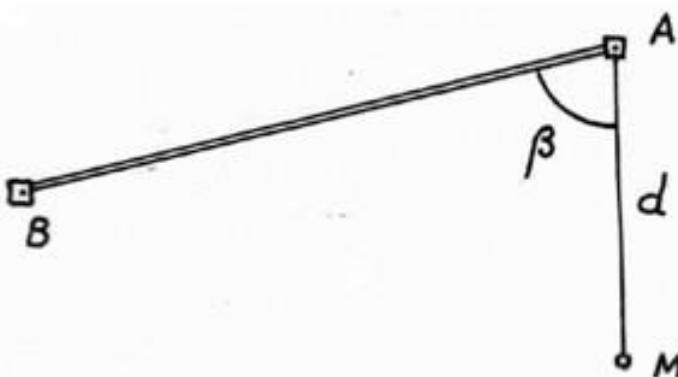
*Рисунок 2. Схема разбивки способом полярных координат*
