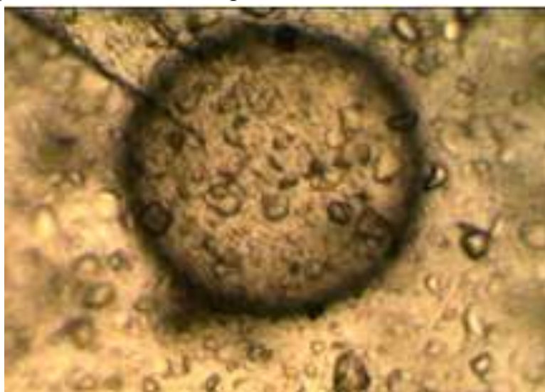
Рисунок 2. Капля эмульсии октана в воде, стабилизированная микрочастицами талька с концентрацией 10 (б) % (масс) в расчете на водную фазу. Увеличение 100х. Диаметр капли 225 мкм
