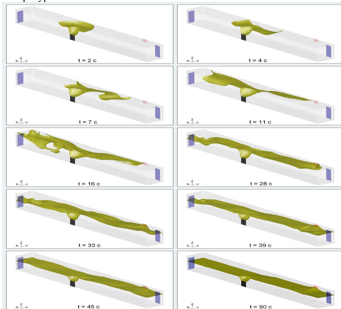
Рисунок 2 – Развитие тепловой границы ( 70^{\circ}\text{C} ) дымового слоя во времени
