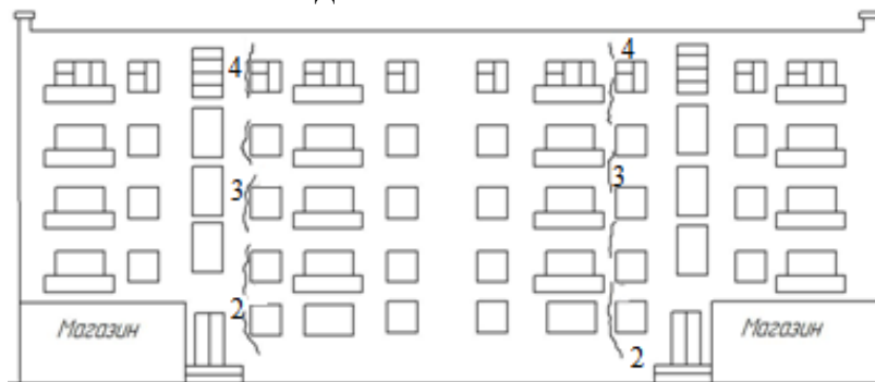
Рисунок 1 – Дом 49. Трещины стены главного фасада
