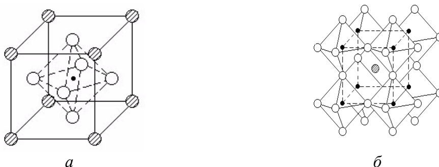
Рисунок 2 – Кристаллическая структура типа перовскита: а – элементарная ячейка; б – остов из октаэдров. \bigcirc А и \bullet В – катионы, \bigcirc X – анионы
