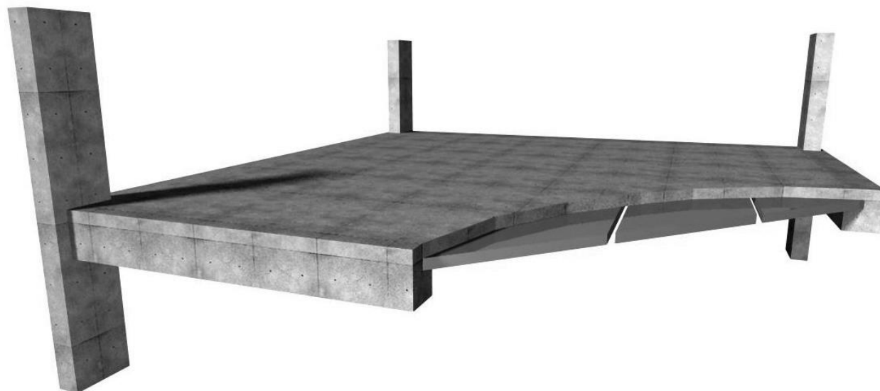
Рисунок 2 – Вариант-2 расчетной схемы. Сборное перекрытие сечением 60мм + 100мм
