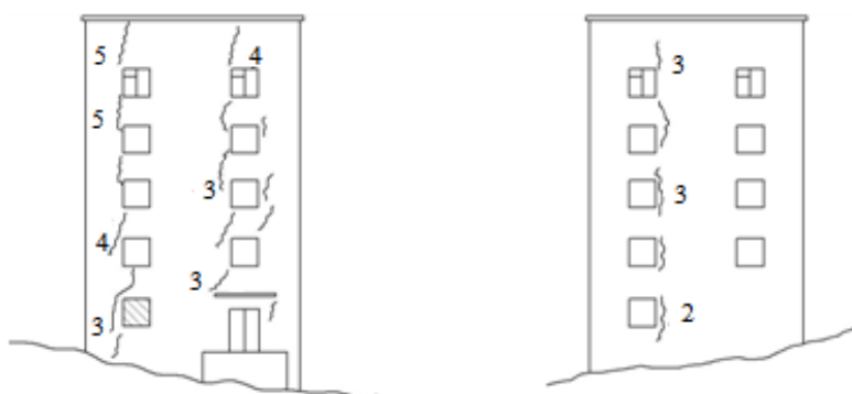
Рисунок 3 – Дом 49. Трещины стен западного и восточного торцов здания
