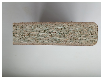
Рисунок 3 – Образец плиты с разными видами стружки
