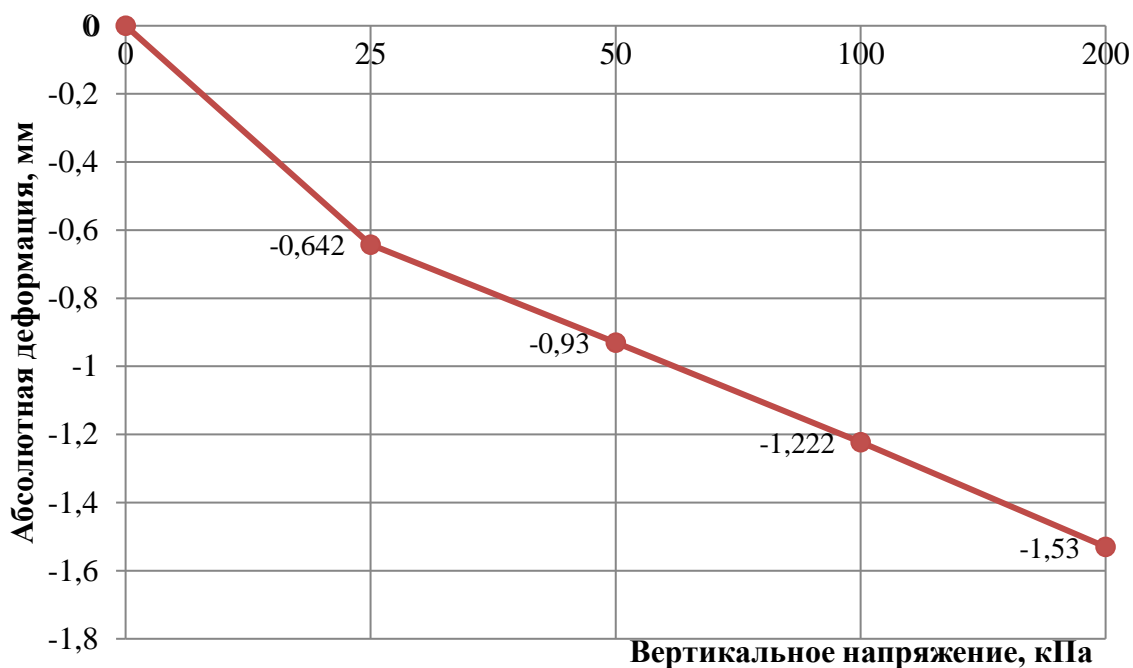
Рис. 2. Зависимость абсолютной деформации от вертикальных напряжений.
