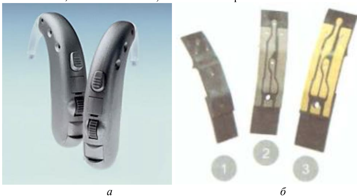
Рисунок 3. Составные части заушного слухового аппарата: а – заушная (аппаратная) часть; б – пространственный печатный узел - шасси аппаратной части (этапы изготовления: 1 – струйное формообразование основания, 2 – лазерное структурирование, 3 – металлизация)
