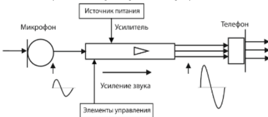
Рисунок 1. Функциональная схема слухового аппарата
