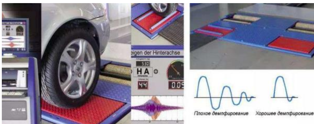
Рисунок 1 – Вибростенд для диагностики ходовой части автомобиля
