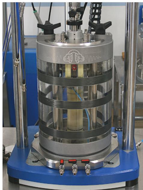
Рис. 1. Принципиальная схема динамического нагружения методом резонансной колонки (а) и камера ГТ.2.3.22, реализующая указанную схему (б).
