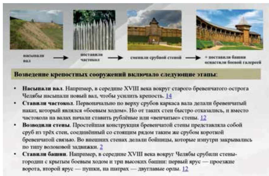
Рис. 12. Этапы возведения деревянной крепости
